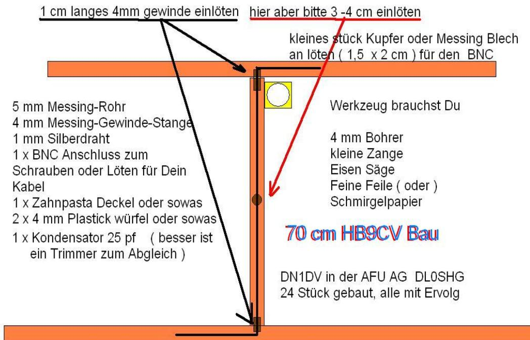
der BNC Anschluss sollte zur Mittleren Schraube Zeigen, auf die 2 Muttern kommen.
