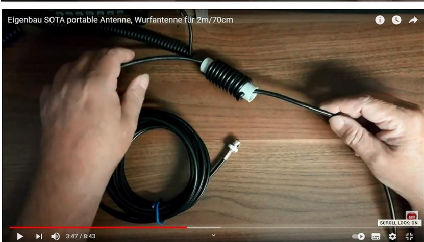
Die Spule ist auf ein Plastik Rohr gewickelt = 7 bis 9 Windungen
