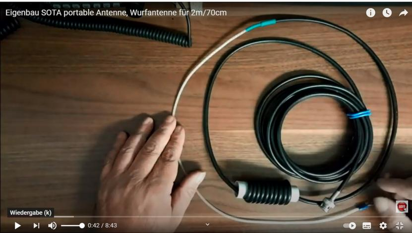
Normales RG58U Koaxial Kabel als Wurfantenne oder in einem Elektriker Schutz Rohr dann als Rundstrahler .
