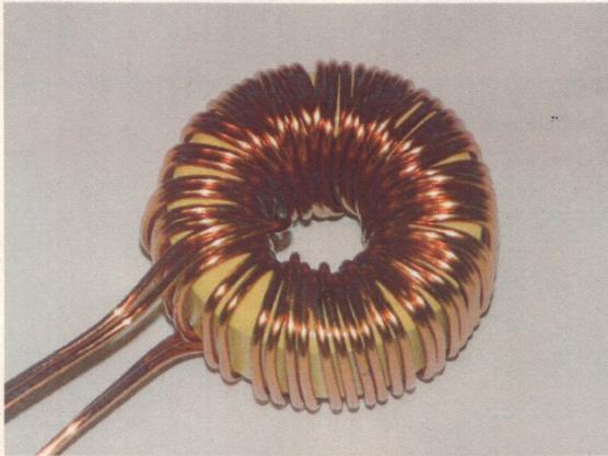
noch ein Filter, da nur eine Spannung erzeugt werden soll. Die alte Siebdrossel L1 muss modifiziert werden. Ihre 4 Spulen werden abgewickelt. Nun werden mit zwei parallelen 1-qmm-Kupferlackdrähten je 29 Windungen aufgewickelt. (Drahtlänge  $2 \times 1,3 \text{ m}$ ). Die neue Spule wird in den alten +5V-Zweig der L1 gelötet. Alternativ kann man bei Reichelt ein Rinkern T106-26 (1,10€;  $AL=93\text{nH}$ ) kaufen und mit 29 Windungen ( $80\mu\text{H}$ ) bewickeln.
