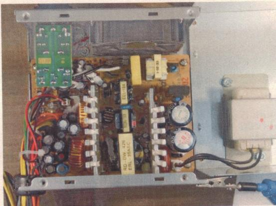
Hier wurde das Netzteil geöffnet, und der Deckel zur rechten Seite gelegt. Auf dem Deckelblech ist die PFC-Spule befestigt (power factor correction), die die pulsweise Belastung des Stromnetzes vermindern soll.
