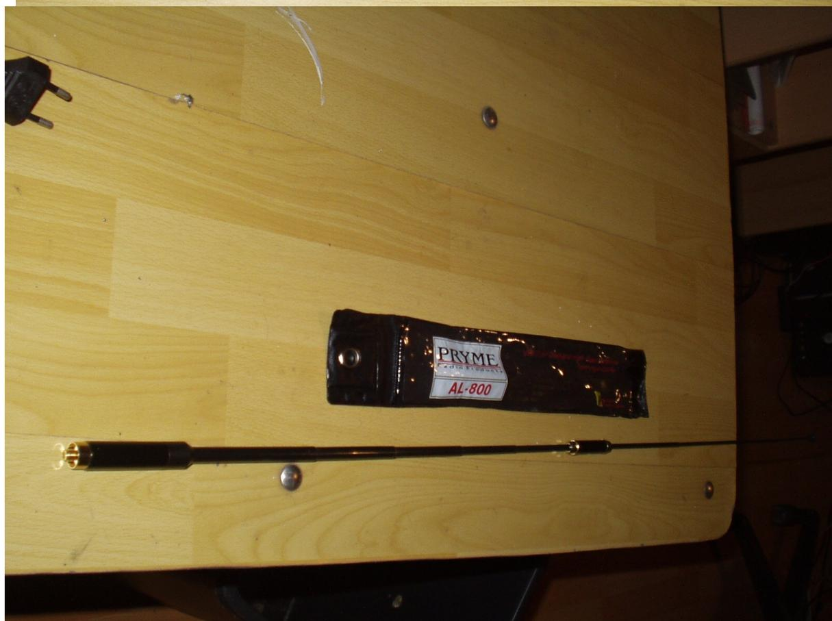
bei ausziehen der Antenne von 70cm kommt man über 3 dB Gewinn
